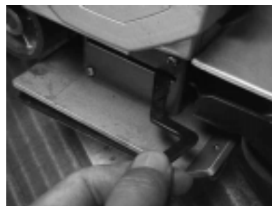
側面のレバーを倒しベルトを装着
