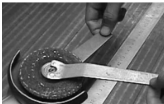
専用工具を使った研磨ディスクの交換
