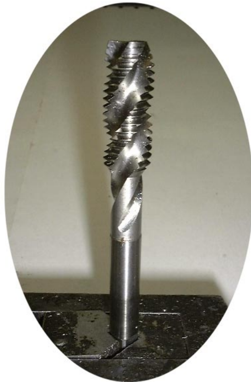
スパイラルタップ ボール盤で専用のチャックを使ってタッピングを行います。
