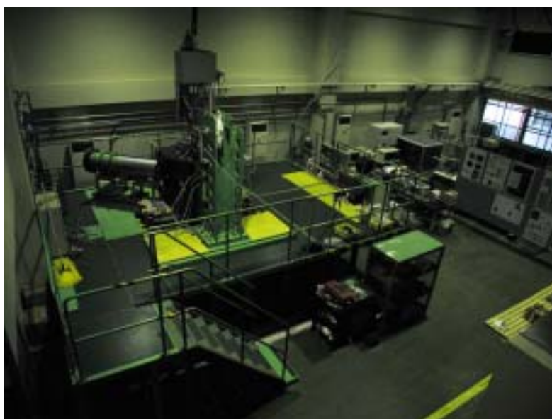
図1 ナノメカニクス分野の実験室の様子 左側の大きな装置は超高純度半導体結晶成長装置
