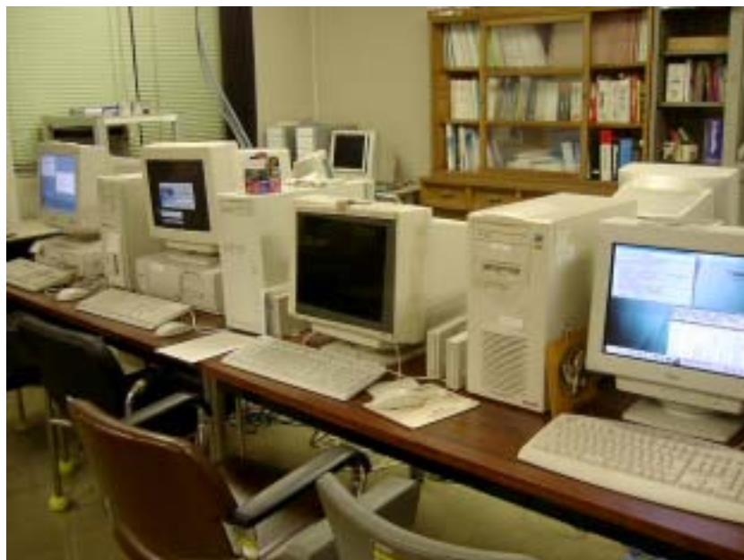
図2 ナノメカニクス分野の計算機室の様子 多くのコンピュータは OS として Linux を使用している。また、4 台のコンピュータが 1 台のディスプレイを共有している。
