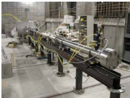
図 2 デトネーション駆動衝撃波管 (Expansion tube に改造中)
