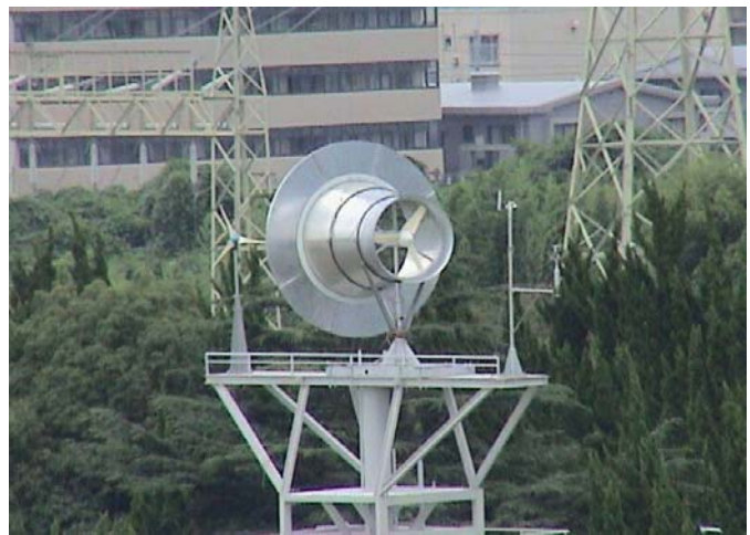
図2 風レンズ風車のフィールド実験
